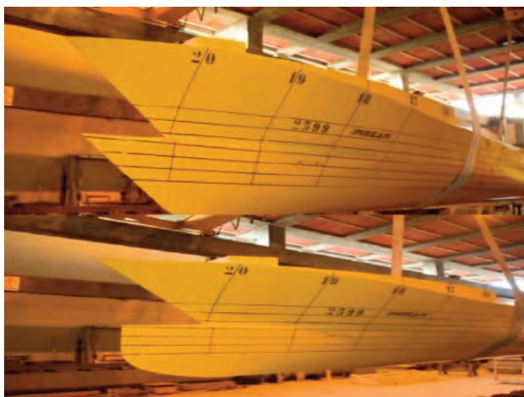
Figura 3 - Le due configurazioni di carena a confronto: prora «rosto» (sopra) e prora «axe-bow» (sotto).
