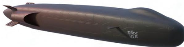
Immagine al computer del concetto SMX31E, presentato da Naval Group e relativo a un sottomarino a propulsione convenzionale dalle forme molto avviate e che fa interamente ricorso all'energia elettrica fornita da batterie agli ioni di litio (Naval Group).
