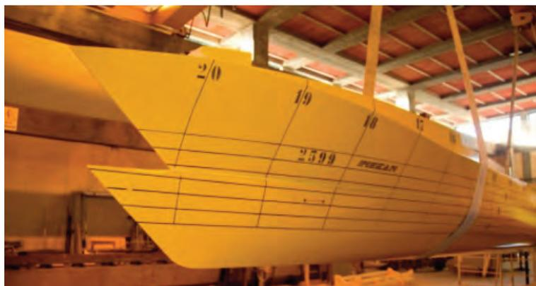
Figura 2 - Il modello di carena con rostro impiegato per le prove sperimentali presso la vasca del CNR-INM.
