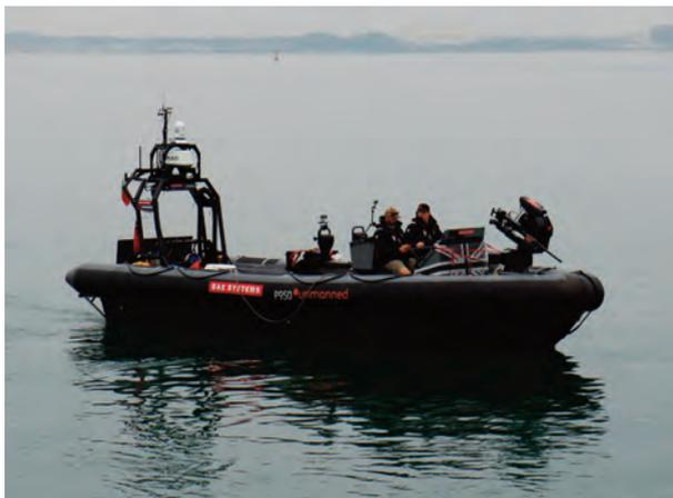
Il RHIB remotizzato BAE Systems P950, pensato per la protezione dei porti e, in prospettiva, per la difesa ravvicinata delle navi da sciame di droni. Il numero e tipo di minacce per la sicurezza marittima è in grande crescita.
