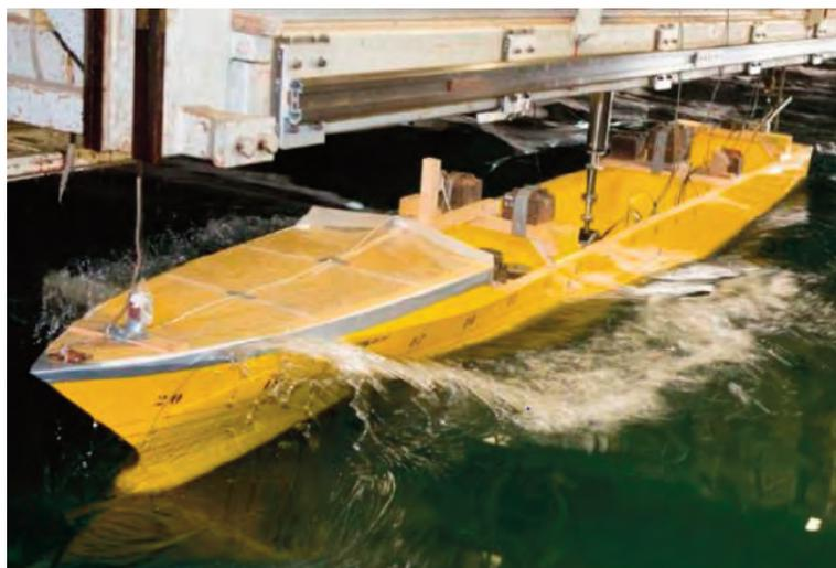
Figura 4 - La terza configurazione di carena con bulbo tradizionale.
