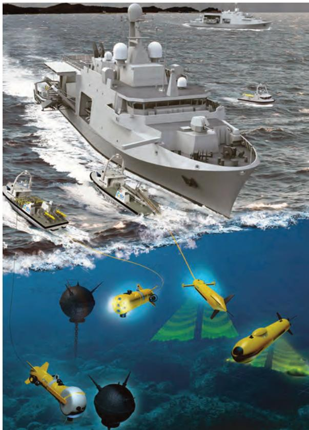
Rappresentazione pittorica del concetto d'impiego dei futuri cacciamine belga-olandesi, fondato su un massiccio impiego di mezzi autonomi e a controllo remoto. Il programma prevede la realizzazione di 12 unità, assegnate al consorzio Belgian Naval & Robotics (BNR), formato da Naval Group e ECA Group (BNR).
